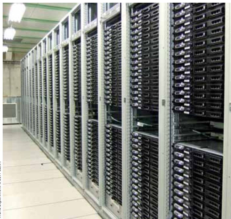
Figura 1. Un bastidor ( rack ) del sistema de trigger i d'adquisició de dades (TDAQ) de l'experiment ATLAS de l'LHC del CERN (Ginebra).
